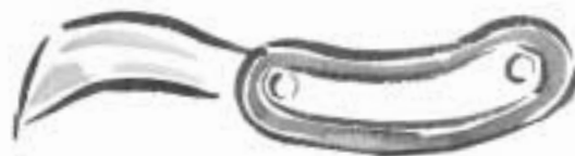
d) Cuchillo de poda con hoja doblada o curvada y un mango fuerte, que puede ser firmemente
