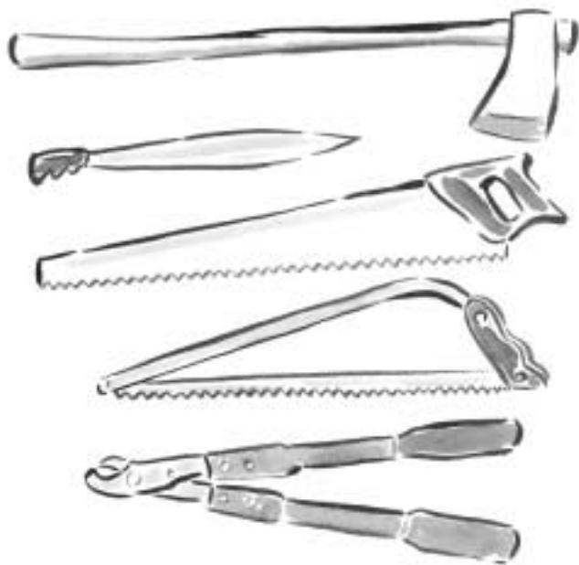
a) Herramientas manuales hacha, cuchillo o machete, serrucho manual, seguela y podadora con amplio mango
