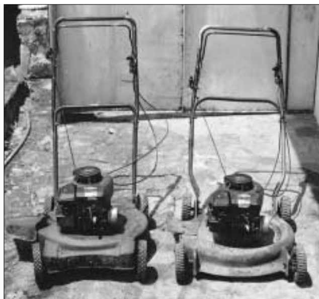
Figura 2 Cortadores de césped manuales con motor de combustible. En la izquierda un modelo más liviano con una cobertura de metal delgado; a la derecha, el mismo modelo pero con una cobertura de metal más grueso
